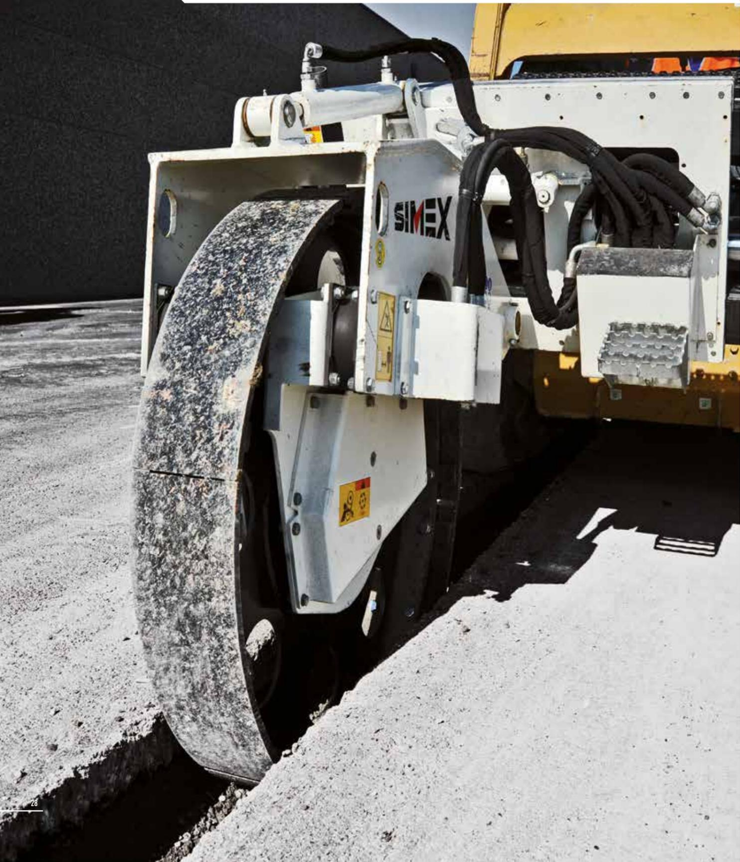
■ Progettati per compattare il fondo degli scavi in sezione, i compattatori vibranti a ruota Simex CT, garantiscono un fondo solido, omogeneo e ben compattato, che non cede nel tempo e garantisce la massima sicurezza nella circolazione stradale.
